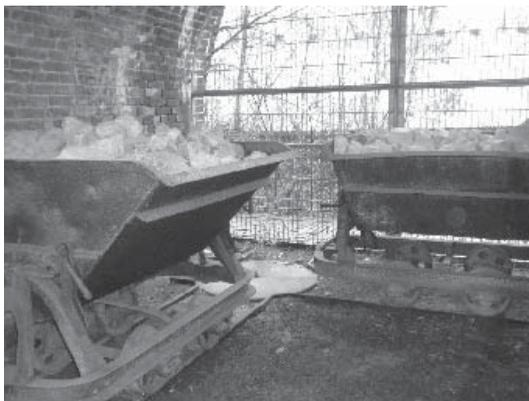
*In diesen Loren wurde der Kalk transportiert. Über die Rheinische Strecke, die in unmittelbarer Nähe vorbei führt, war der Kalktrichterofen ans Schienennetz angebunden.*
