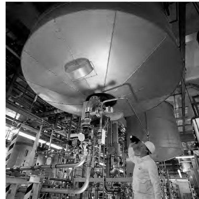
*In gewaltigen Behältern aus Edelstahl werden die Bakterien zur Acarbose-Produktion gezüchtet und anschließend wieder von der Ansatzbrühe getrennt.*
